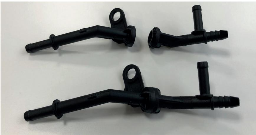
**Bild 1.** Da das zweiteilige Kühlmittelverteilerrohr im Rotations-schweißen verbunden werden sollte, kam PPS als Material nicht in Frage © Kuraray
